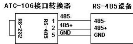
C、检查 RS-232 接口信号电平（TD、DTR、RTS）是否低于 $\pm 5V$ ，若低于 $\pm 5V$ 时，可在所提供的 RS-485 接线端子的+12V 与 GND 之间外接一个+5V 至+12V 的直流电源。
